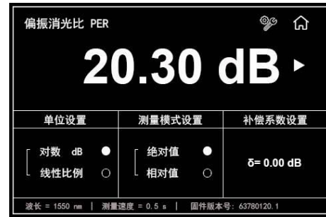
图B. 偏振消光比测量与设置
